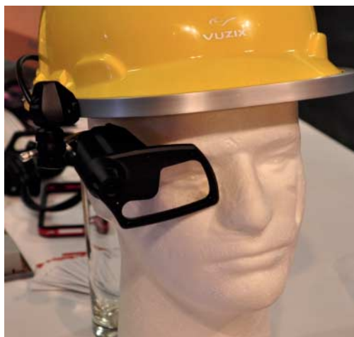
Bei Vuzix einäugigem HMD verlässt das Licht des seitlich angebrachten LCD das Brillenglas erst an der eingepprägten Hologrammstruktur.
