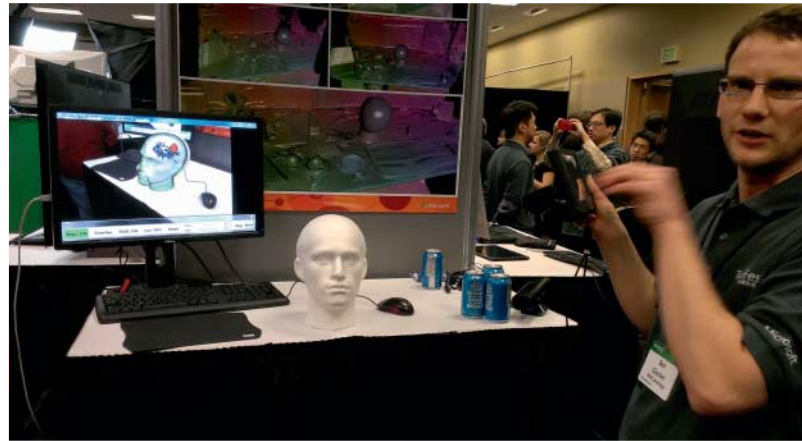
Der Computer fügt 3D-Daten aus einer Magnetresonanztomografie in das 3D-Modell eines zuvor gescannten Kopfes ein.
